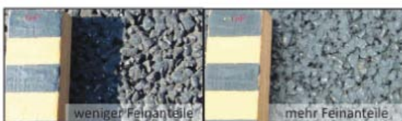
Abb. 3: Zwei semidichte Beläge mit gleichem Grösstkorn-durchmesser und Hohlraumanteil (SDA 4-12) aber unterschiedlichen Feinanteilen (Quelle: G+P)
